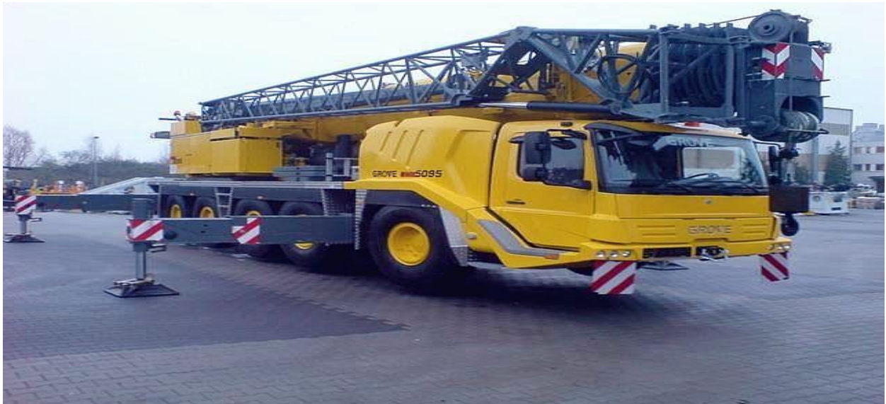
100 TON ALL TERRAIN CRANE
