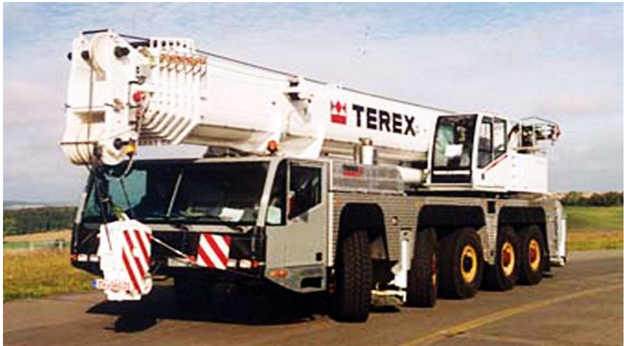
200 TON ALL TERRAIN CRANE
